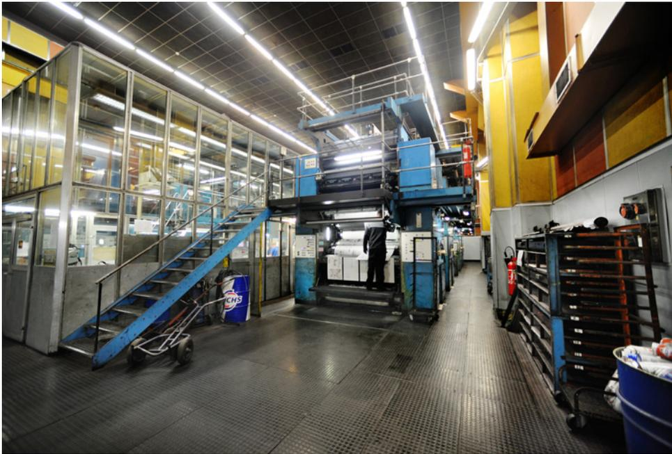
Le calage machine est délicat car entre les corrections effectuées en cabine avec le conducteur et la machine qui continue à tourner, il y a beaucoup de gâche papier.
